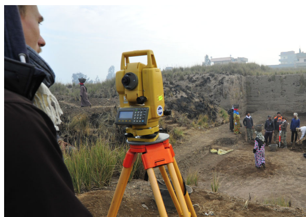
Ryc. 7. Pozyskiwanie danych tachimetrycznych podczas pracy na stanowisku archeologicznym Tell el-Farcha
