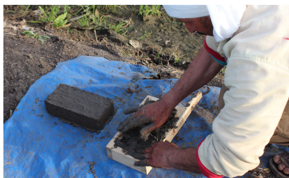
Ryc. 4. Proces powstawania współczesnej cegły mułowej. Ceglarz wyrównuje górną powierzchnię powstającej cegły mułowej w specjalnej drewnianej formie Fig. 4. Creating a new mudbrick. The brickmaker is aligning upper surface of new brick in special wooden mold
