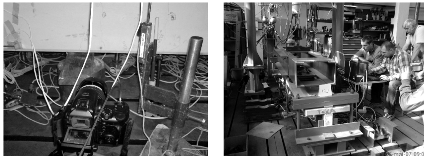
Photo 3. Weight test on bias ferro-concrete beam braced with carbon lamells in VÚD laboratory Fot. 3. Test obciążeniowy belki żelbetowej wzmocnionej taśmami węglowymi w laboratorium VÚD
