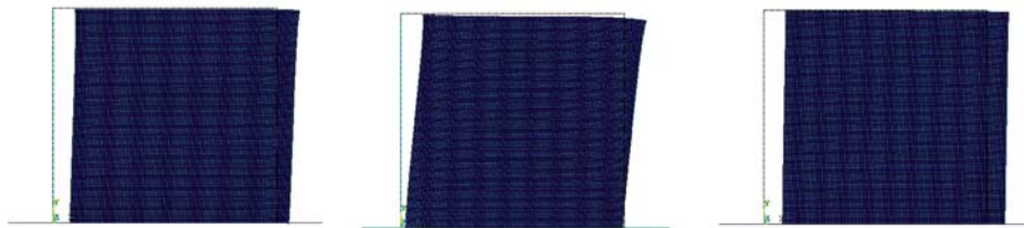
Rys. 14. Deformacja dla wybranych przykładów: a) materiał o strukturze II \mu = 0,1 , b) materiał strukturze II \mu = 0,2 , c) materiał o strukturze II \mu = 0,2 orientacja pozioma
