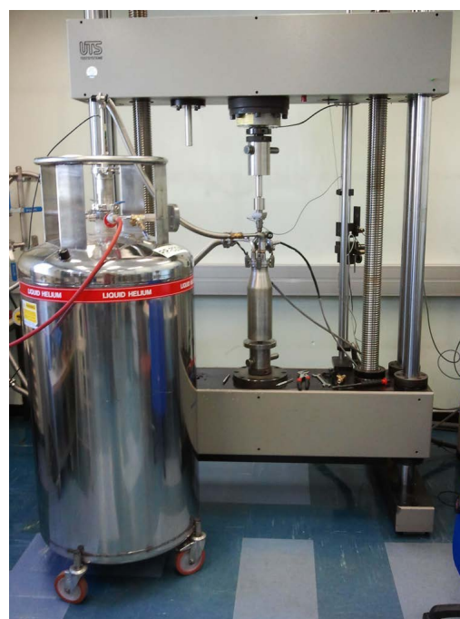
Rysunek 4.8.: Zestaw eksperymentalny zamontowany na maszynie wytrzymałościowej UTS.
