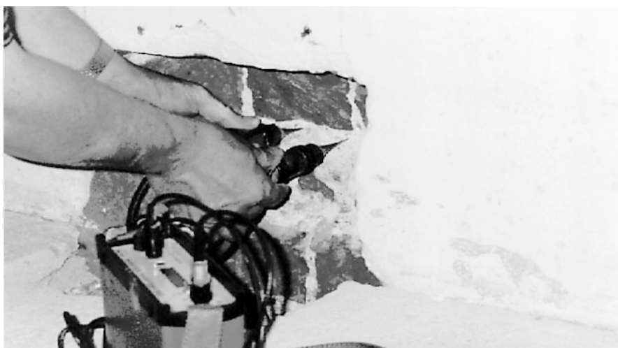
Rys. 4. Sposób badania zaprawy między ceglami z wykorzystaniem głowic eksponencyjnych
