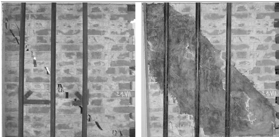
Rys. 6. Badanie wzmocnienia pękniętego muru ceglanego wykonanego z kilku warstw siatki szklanej mocowanej na polimerze PS [8]
