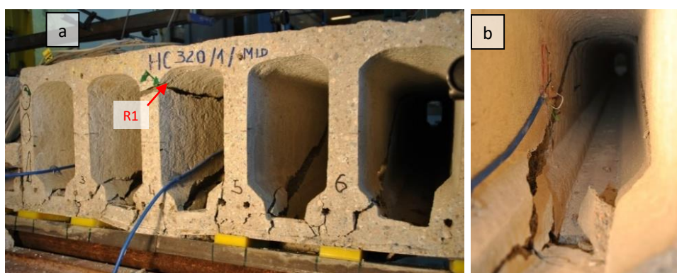
Fot. 24. Zniszczenie strefy podparcia płyty HC320m.
