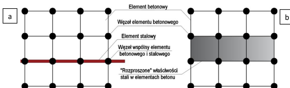
Ryc. 67. Reprezentacja modeli zbrojenia w betonie: model dyskretny (a), model rozproszony (b) (wg (Tavarez 2001)).
