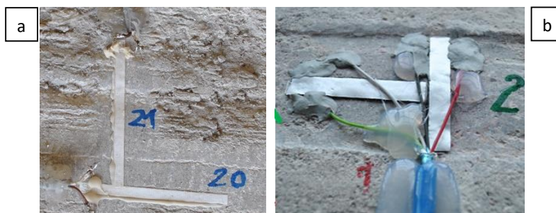
Fot. 17. Tensometry na powierzchni płyty (a) oraz powierzchni przygotowanej do nadbetonowania (b).
