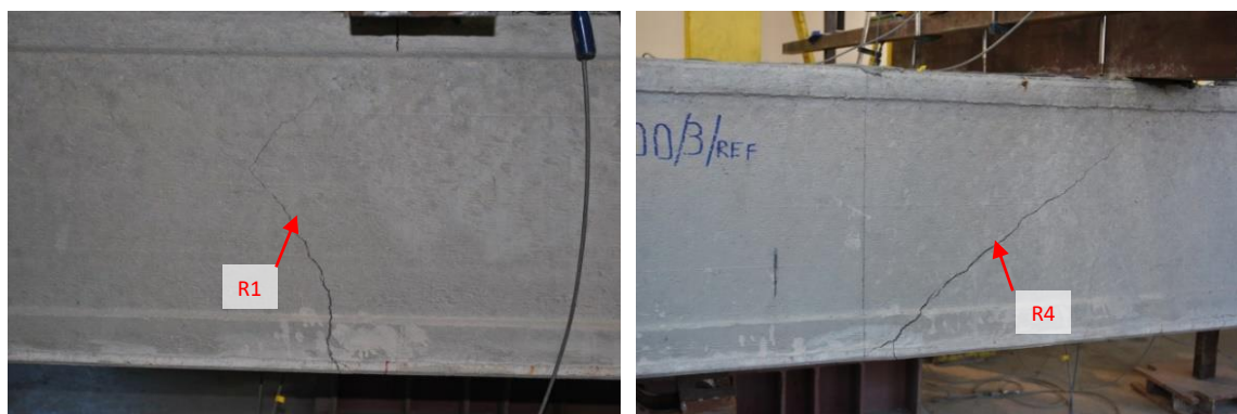
Fot. 21. Zniszczenie elementu HC500r w linii obciążenia.
