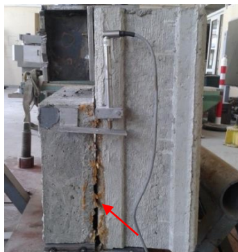
Ryc. 57. Odspojenie nadbetonu od płyty.
