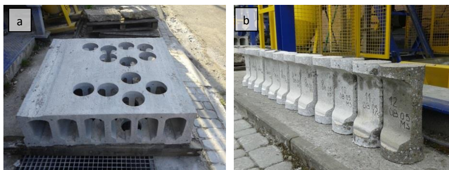
Fot. 42. Pobrane próbki wycinkowe z fragmentu płyty kanałowej.
