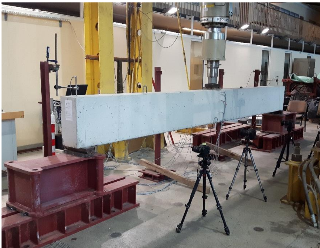
Rys. 4.46. Aparatura do bezdotykowego pomiaru wizyjnego
