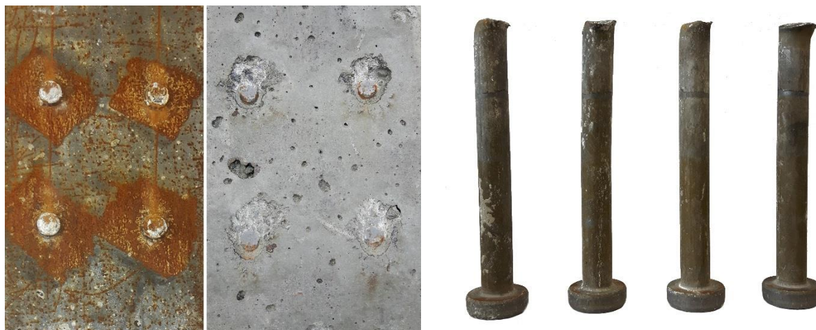
Rys. 4.26. Formy zniszczenia: powierzchnia stalowej blachy, powierzchnia betonu i łączniki sworzniowe
