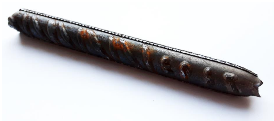
Rys. 4.14. Próbką stali zbrojeniowej po zerwaniu w statycznej próbie rozciągania
