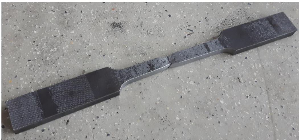
Rys. 4.20. Próbką stali konstrukcyjnej po zerwaniu w statycznej próbie rozciągania
