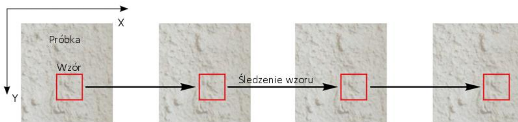
Rys. 4.3. Śledzenie wzorca z wykorzystaniem sekwencji obrazów
