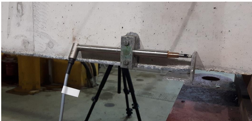
Rys. 4.44. Czujnik indukcyjny do pomiaru poślizgu
