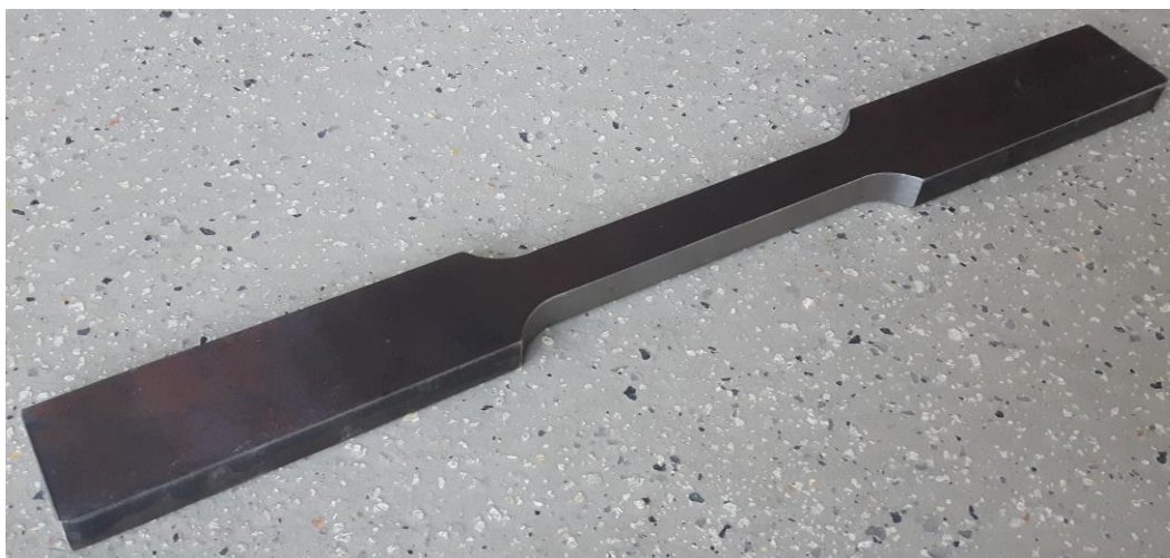
Rys. 4.15. Próbką wykorzystywana w badaniu statycznej próby rozciągania dla blach
