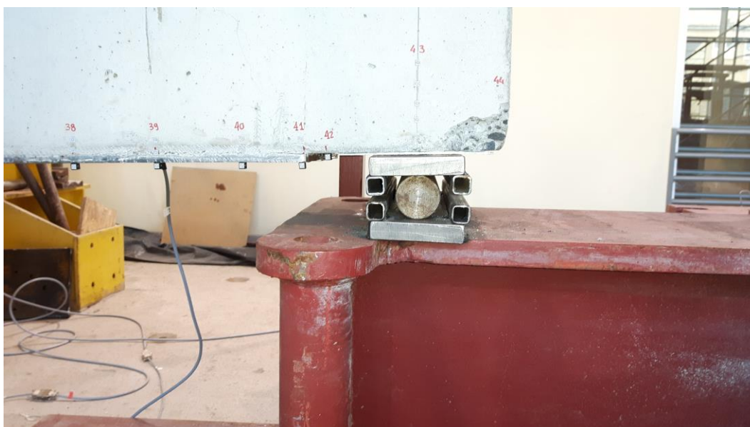
Rys. 4.39. Łożysko przegubowo-przesuwne
