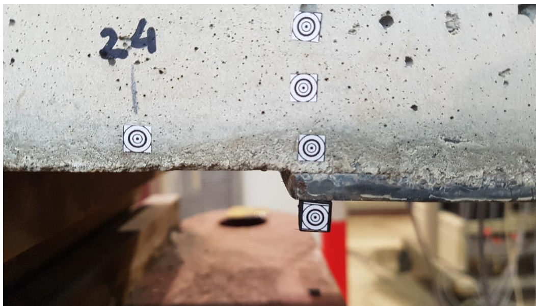
Rys. 4.67. Markery mierzące poślizg stalowej blachy względem części betonowej belki
