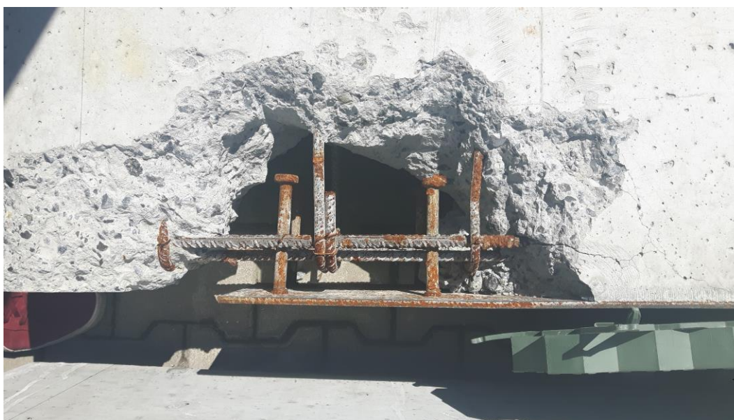
Rys. 4.74. Łącznik sworzniowe po zniszczeniu belki
