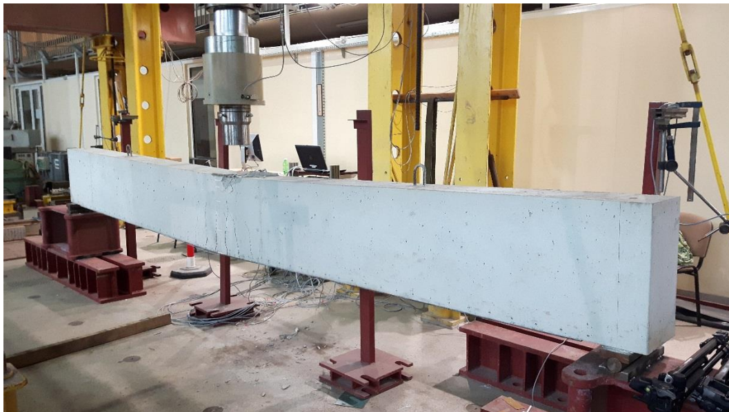
Rys. 4.53. Belka zespolone typu stalowa blacha-beton po przyłożeniu obciążenia niszczonego
