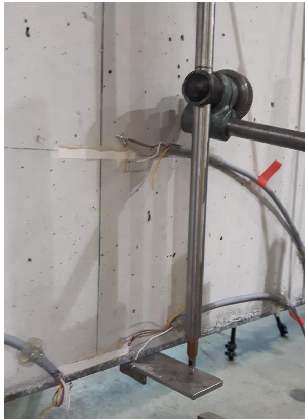
Rys. 4.41. Czujnik indukcyjny do rejestracji przemieszczeń
