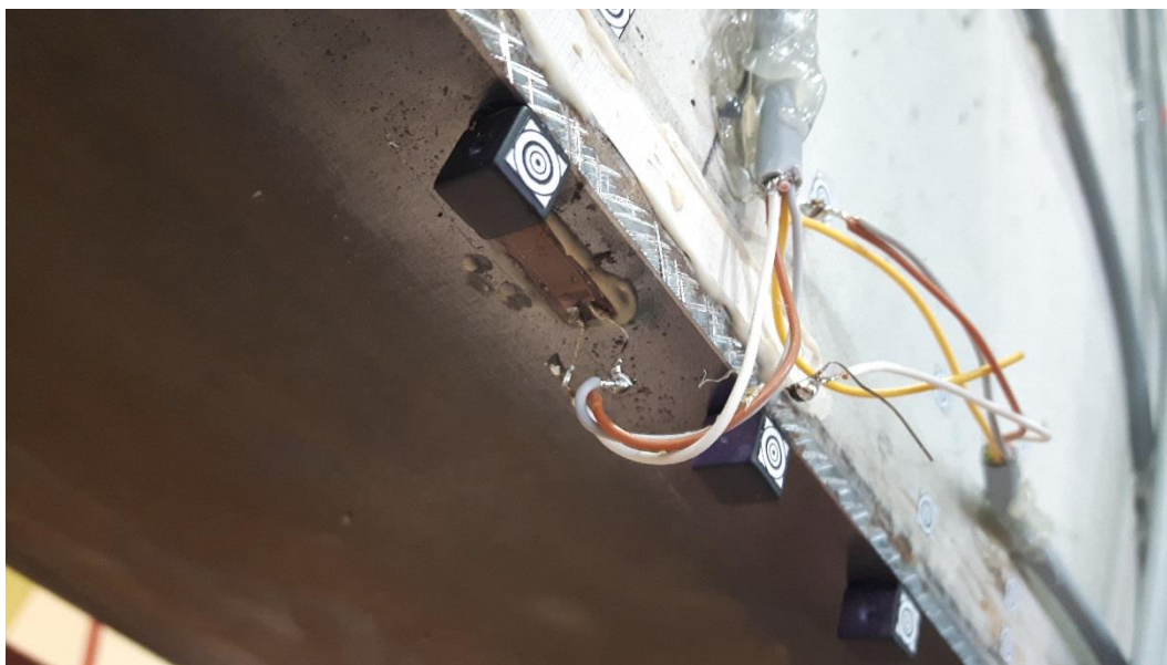
Rys. 4.42. Tensometr foliowy do pomiaru odkształceń na powierzchni stalowej blachy
