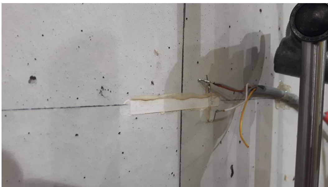
Rys. 4.43. Tensometr papierowy do pomiaru odkształceń na powierzchni betonu
