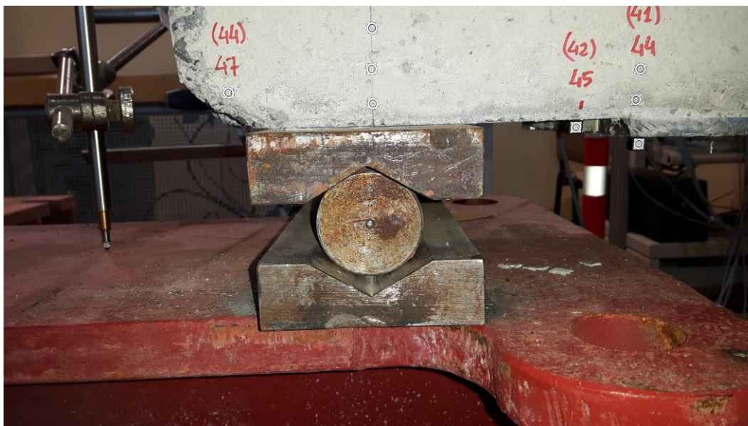
Rys. 4.38. Łożysko przegubowo-nieprzesuwne
