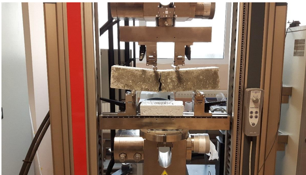
Rys. 4.10. Próbką betonowa poddana badaniu na zginanie
