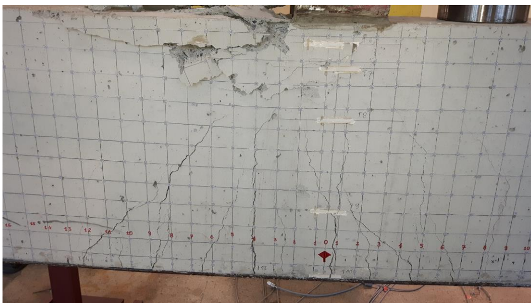
Rys. 4.55. Zarysowanie i zmiażdżenie belki zespolonej typu stalowa blacha-beton przy obciążeniu niszczącym w środku rozpiętości
