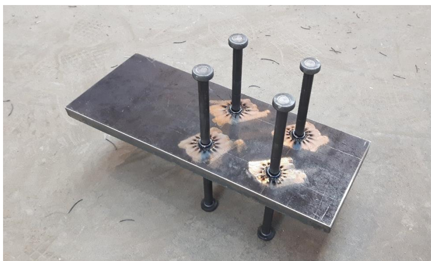
Rys. 4.21. Stalowa blacha z zamontowanymi łącznikami wiotkimi typu Nelsona
