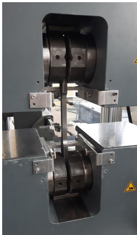
Rys. 4.16. Badanie statycznej próby rozciągania blach
