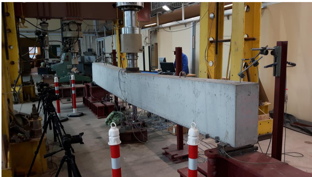
Rys. 4.50. Ugięcie belki zespolonej typu stalowa blacha-beton w trakcie badania
