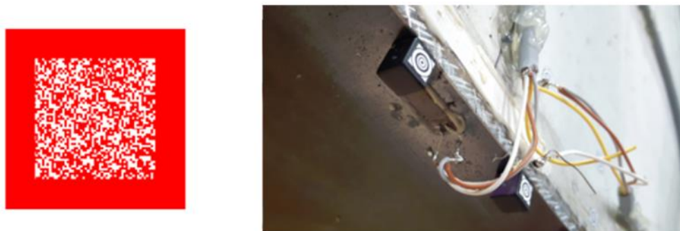
Rys. 4.2. Projekt przykładowego markera na bazie QR kodu (po lewej stronie) oraz zastosowanie markera na badanej konstrukcji (po prawej stronie)
