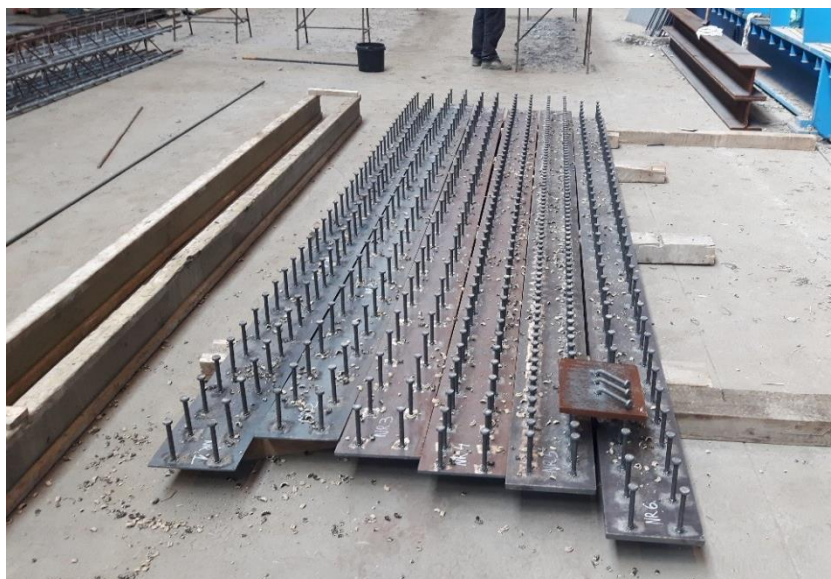
Rys. 4.29. Stalowe blachy z zamontowanymi łącznikami Nelsona
