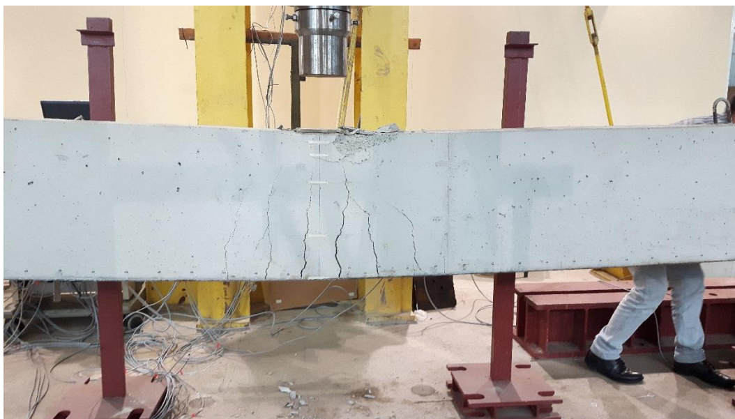
Rys. 4.54. Zarysowania w środku rozpiętości belki
