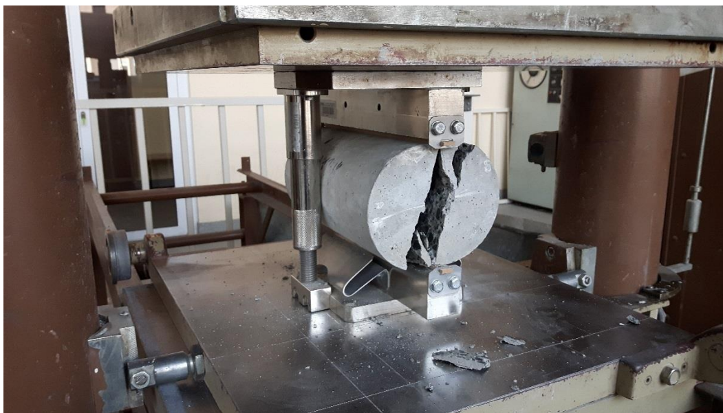
Rys. 4.9. Próbką betonową poddana badaniu wytrzymałości na rozciąganie przy rozłupywaniu
