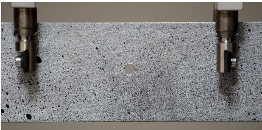
Rys. 4.1. Zmatowiona próbka z naniesionym za pomocą farby w spreju losowym wzorcem
