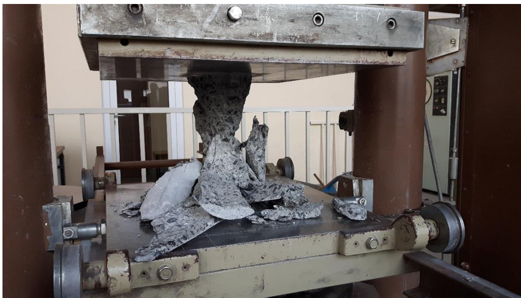
Rys. 4.8. Próbką betonowa poddana badaniu wytrzymałości na ściskanie
