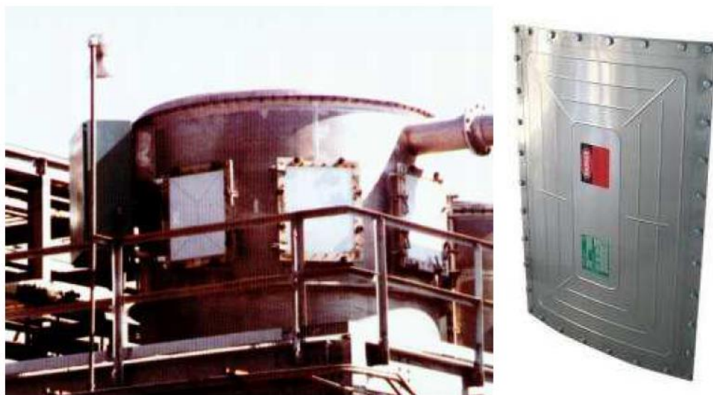
Rys. 2. Przykładowe zastosowanie paneli przeciwybuchowych wg Łapko, Prusiel 2011
