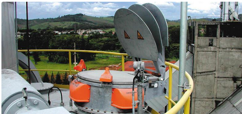
Rys. 3. Klapy wybuchowe
