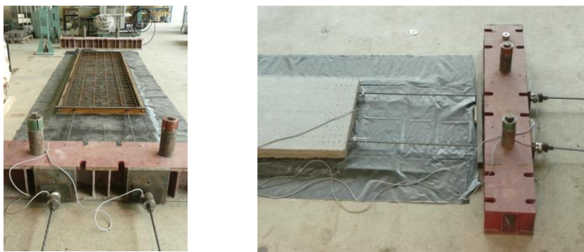
Rys. 2. Widok stanowiska badawczego przed betonowaniem (po lewej) oraz po rozformowaniu i zwolnieniu naciągu (po prawej)
