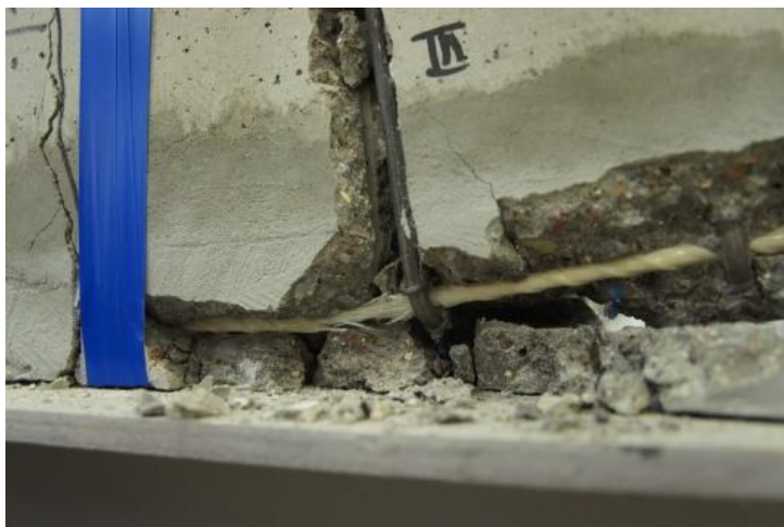
Rys. 7. Belka B1.6.3 po zniszczeniu poprzez zerwanie prętów (fot. O. Korniew)
