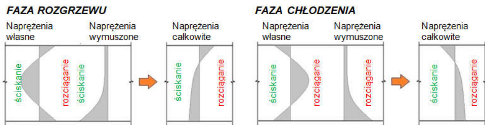
Rys. 8. Rozkład naprężeń całkowitych w przekroju nad palem, wzdłuż wysokości płyty fundamentowej posadowionej na palach
