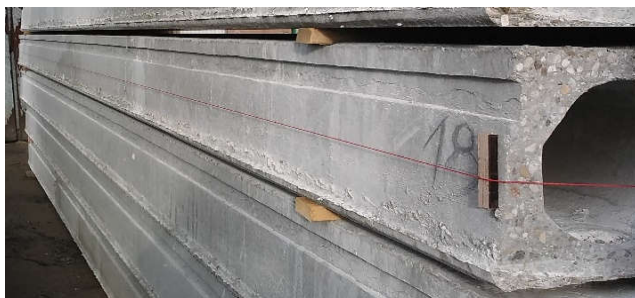
Rys. 2. Zawieszenie żyłki wzdłuż płyty
