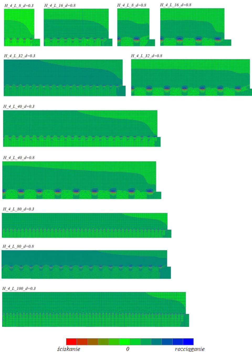
Rys.6. Mapy naprężeń w płycie fundamentowej o wysokości 4 m posadowionej na palach
