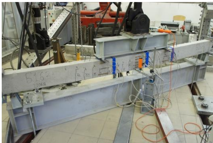
Rys. 6. Belka B1.6.3 pod obciążeniem przed zniszczeniem ( fot. O. Korniew )
