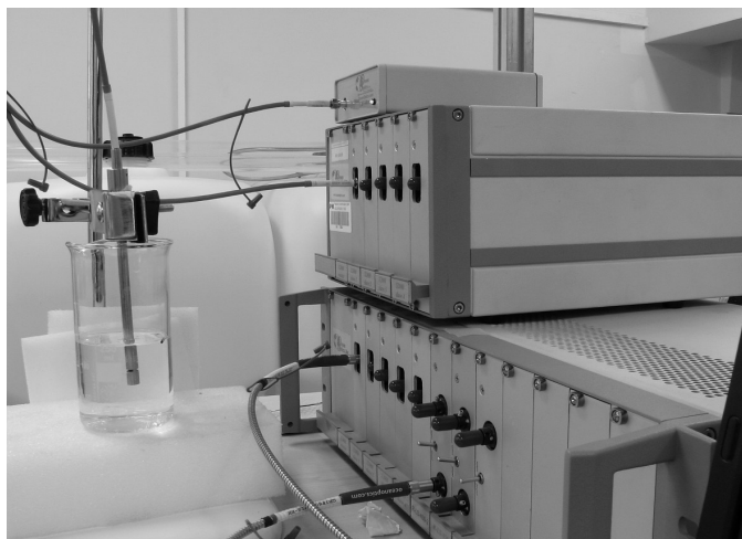
Fot. 3.4. Stanowisko do pomiaru stężenia fenolu oraz stężenia tlenu rozpuszczonego z wielokanałowym spektrofotometrem światłowodowym UV-VIS S2000 Miniature Fiber Optics
