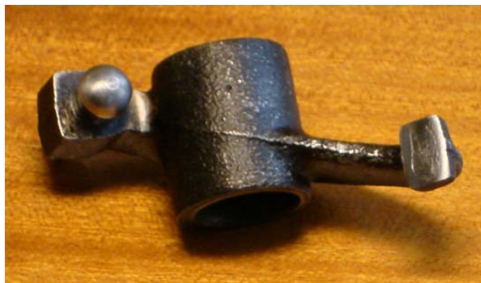
Fot. 3. Widok dźwigenki zaworowej z czaszą kulistą śruby
