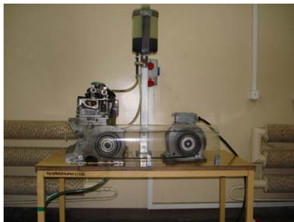
Fot. 1. Widok ogólny stanowiska do badania zużycia skojarzenia popychacz–dźwigienka zaworowa
