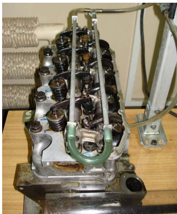
Fot. 2. Widok układu dźwigienek zaworowych i popychaczy oraz elementów układu smarowania
