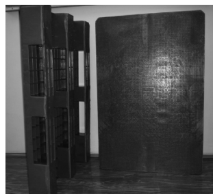
Rys. 4. Europalety z recyklatów polietylenu z 15% dodatkiem tufu [18]
