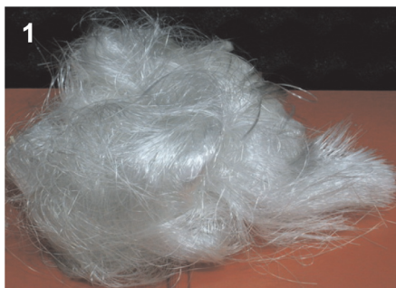
Fot. 1–2. Materiał włóknisty, z którego wykonano próbki do badań akustycznych o nazwie „włókna czesane” i „włókna nieczesane”
