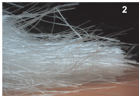
Fot. 1–2. Materiał włóknisty, z którego wykonano próbki do badań akustycznych o nazwie „włókna czesane” i „włókna nieczesane”
