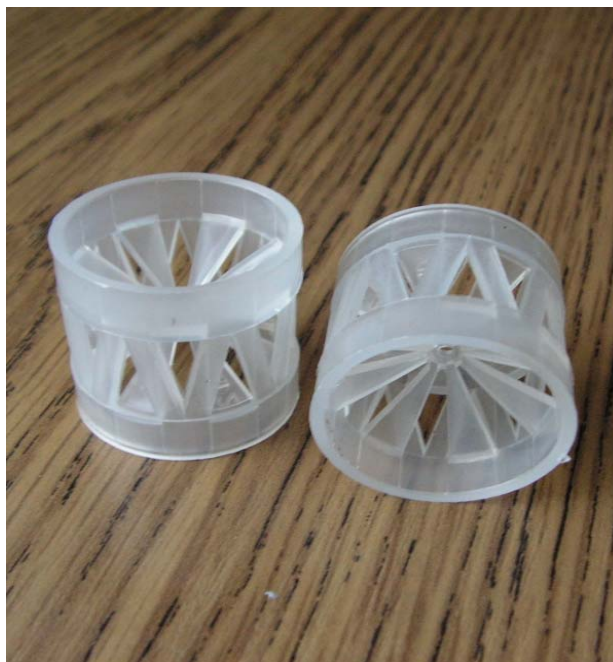
Fot. 2 Pierścienie Białeckiego zastosowane jako wypełnienie złoża
