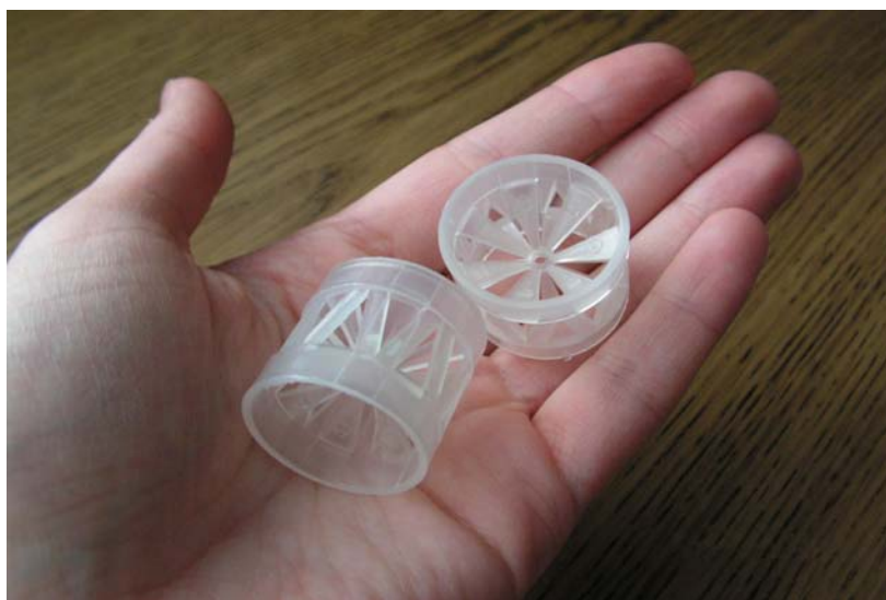
Fot. 1 Pierścienie Białeckiego zastosowane jako wypełnienie złoża
