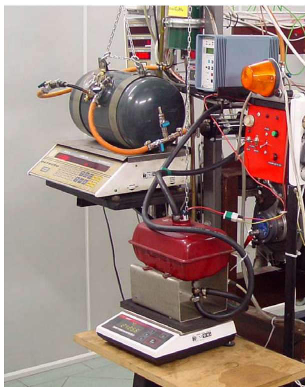
Rys. 6.15. System do pomiaru zużycia paliwa propanu-butanu oraz benzyny (niżej) za pomocą metody wagowej.
