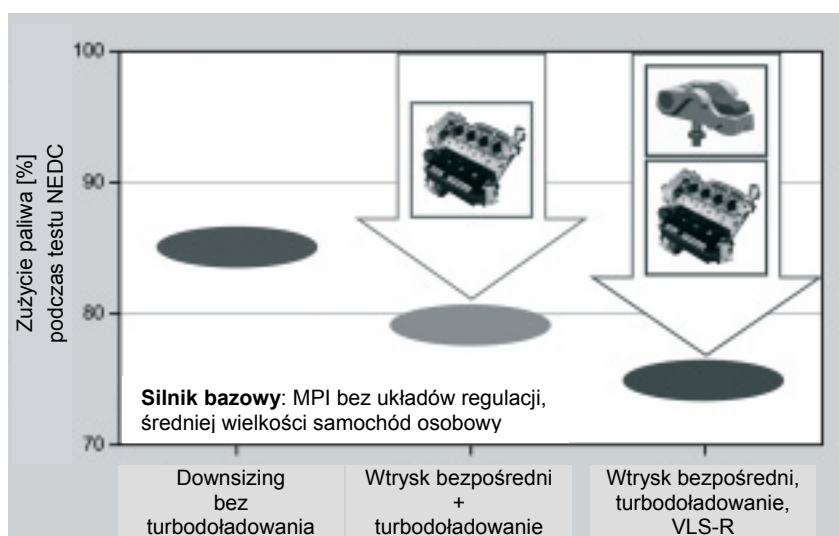
Rys.2.24. Zużycie paliwa turbodoładowanego silnika ZI ze zmiennym wzniosem zaworów dolotowych [2].
