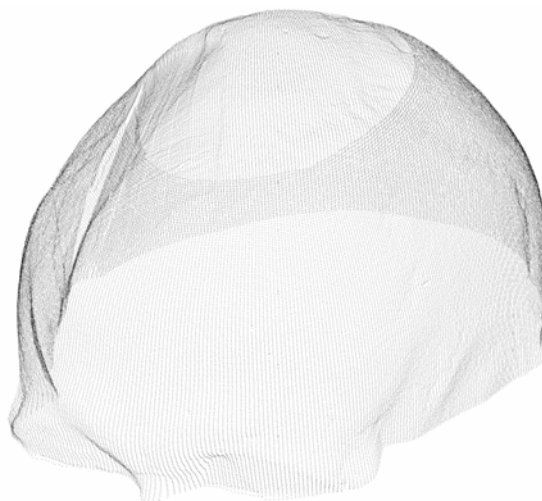
Ryc. 3.5. Przykład interpolacji krigingowej w układzie walcowym zastosowanej do chmury punktów definiującej powierzchnię czaszki
