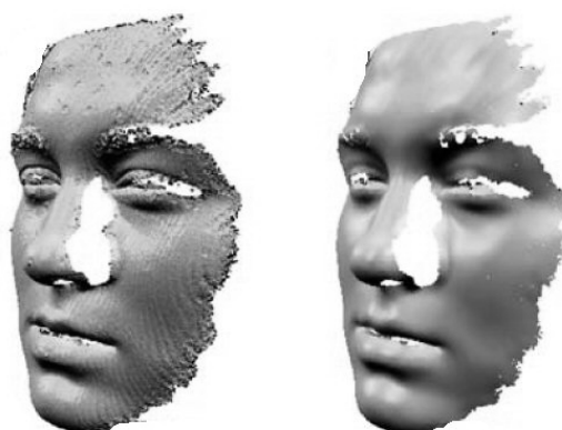
Ryc. 2.25. Filtracja odwzorowania twarzy uzyskanego za pomocą skanera światła strukturalnego [151]
