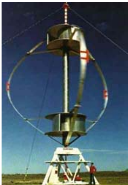
Ryc. 2. Turbina powstała z połączenia wirnika Darrieusa i Savoniusa Fig. 2. Turbine arisen with adherence Darrieus and Savonius rotor
