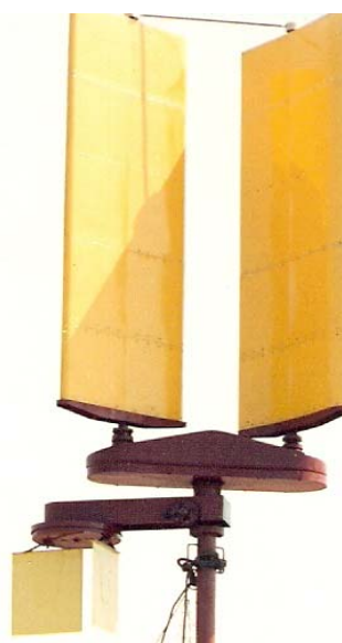
Ryc. 3. Wirnik karuzelowego silnika wiatrowego z mechanizmem naprowadzania na kierunek wiatru Fig. 3. Wind turbine have main rotor with two blades and directing unit
