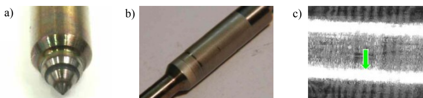
Fot. 3. Przykłady przebarwień i uszkodzeń iglicy rozpylacza [1] Photo 3. Examples of nozzle needle chromatosis and failures
