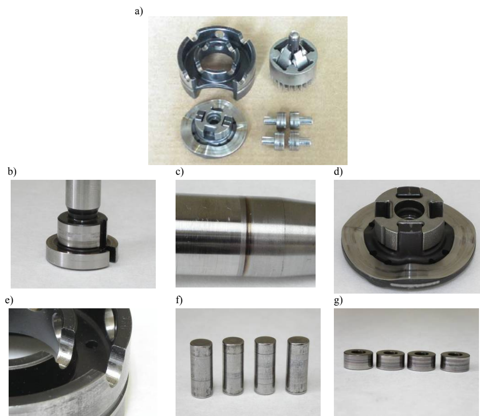
Fot. 4. Widok zestawu wybranych elementów pompy wtryskowej poddawanych ocenie (a) oraz śladów zużycia powstałych na: (b), (c) wale pompy, (d) tarczy krzywkowej, (e) pierścieniu rolek, (f) sworzniach rolek i (g) rolkach [15]
