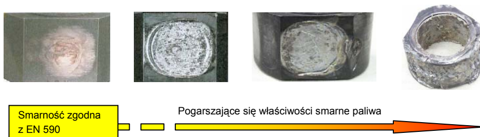
Fot. 5. Obraz wielkości zużycia krzywki napędzającej sekcje wysokociśnieniowe pompy wtryskowej układu Common Rail
