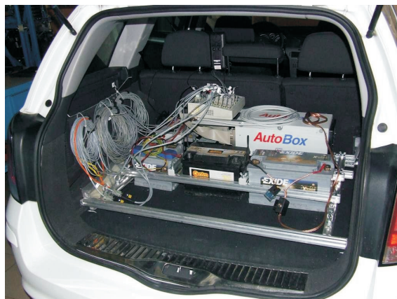
Rys. 2. Wnętrze samochodu testowego z widoczną częścią sprzętową do implementacji prototypowego układu sterowania zmienną charakterystyką tłumienia w zawieszeniu
