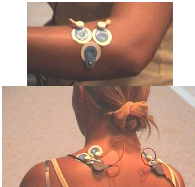
Rys. 8. Przykładowe zamocowanie czujników EMG na osobie badanej w trakcie badań w symulatorze autoPW [2, 6]
