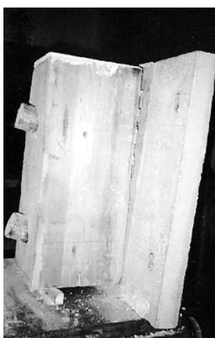
Rys. 7. Stan łączników po zniszczeniu modelu
