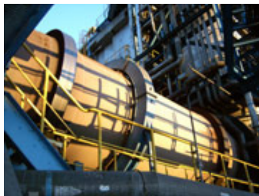
Rysunek 10. Piec obrotowy w spalarni odpadów niebezpiecznych SARPI Dąbrowa Górnicza Sp. z o.o.[7]
