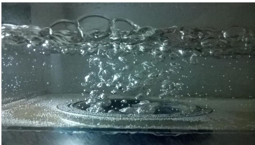
Rys. 2.5. Mechanizm odgazowania fazy ciekłej w strefie „4” (Stanowisko badawcze w Katedrze Inżynierii Chemicznej i Procesowej Politechniki Krakowskiej)
