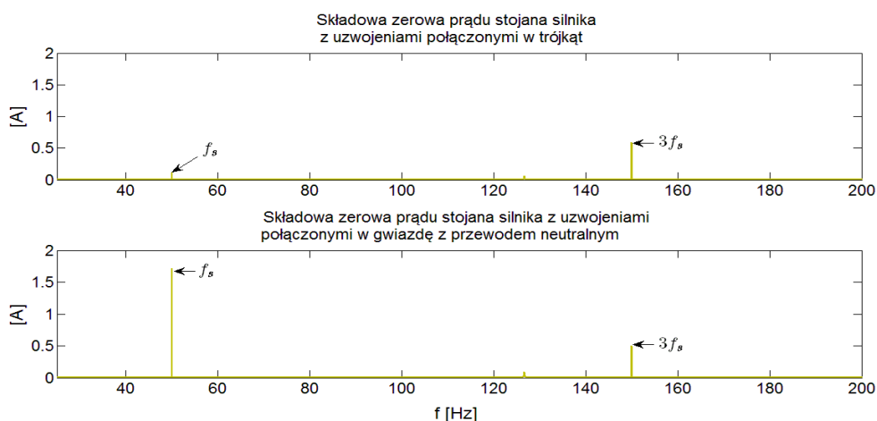
Rys. 3.4-4 Porównanie widm składowej zerowej prądu silnika z uzwojeniami stojana połączonymi w trójkąt i gwiazdę z przewodem neutralnym dla współczynnika niesymetrii \sigma = 1.8\%
