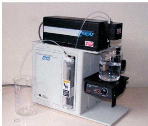
Rys. 5.2. Spektrometryczny licznik cząstek Liquilaz E20 zastosowany przy realizacji badań
