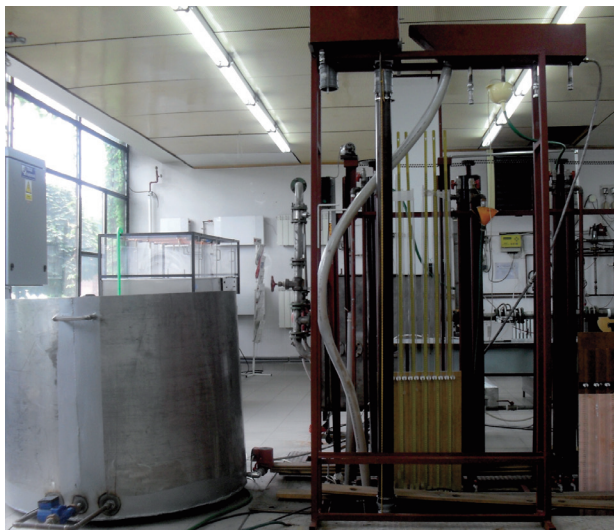
Rys. 8.3. Układ zasilający (zbiornik z zawiesziną, zbiornik przelewowy i flokulator) – stanowisko 1
