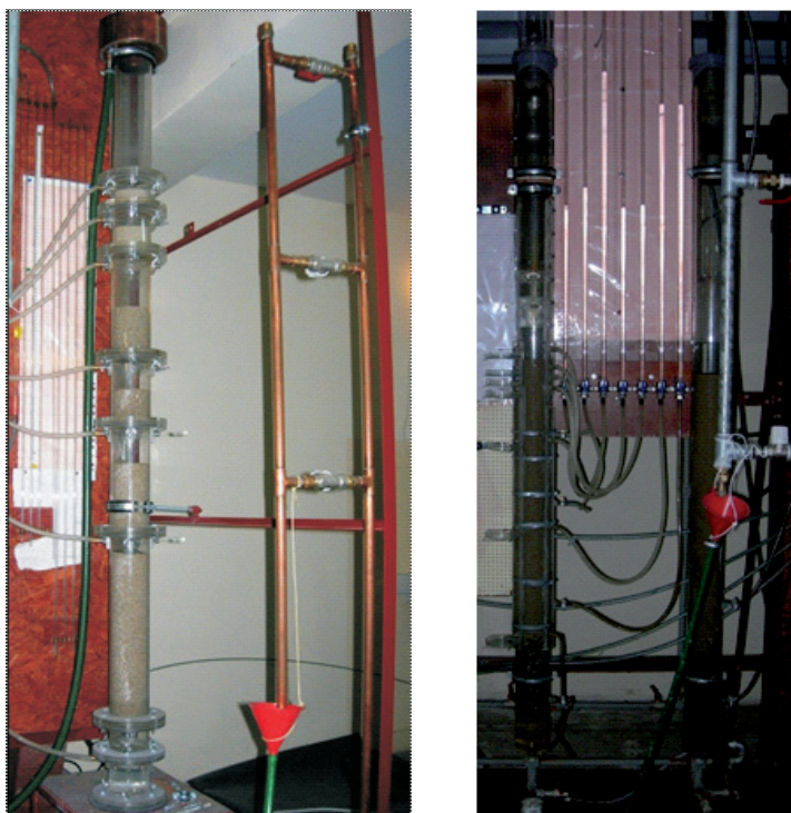
Rys. 8.4. Kolumna filtracyjna skonstruowana z rozkładalnych segmentów – stanowisko 3 (po lewej), kolumna filtracyjna wypełniona złożem – stanowisko 1 i 2 (po prawej)
