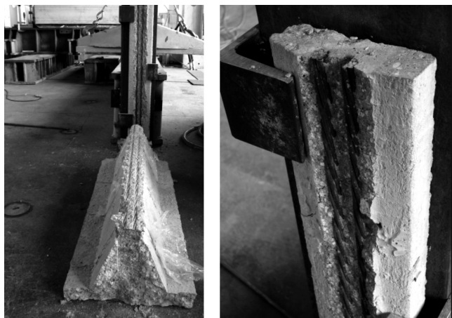
Rys. 3. Widok modelu zniszczenia elementów badanych w II etapie
