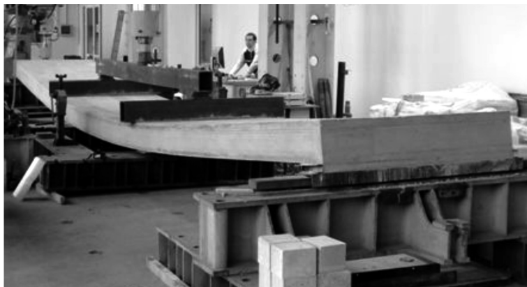
Rys. 17. Widok ugiętego elementu M5
