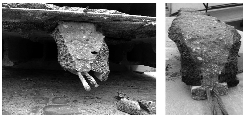
Rys. 16. Widok ściętego żebra stropowego elementu M4
