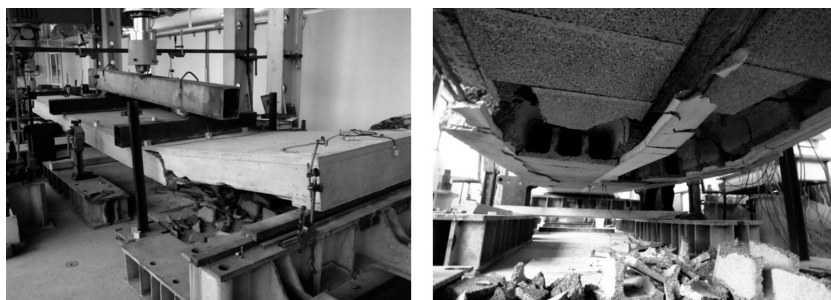
Rys. 14. Widok zniszczenia elementu M4 – widok ogólny i od spodu stropu
