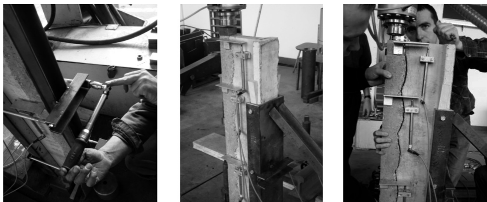
Rys. 2. Widok stanowiska do badań: przyczepności kohezyjnej i sił tarcia (po lewej), przyczepności kohezyjnej (w środku), sił tarcia (po prawej)
