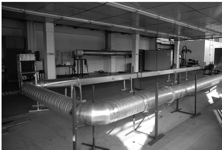
Rys. 12. Stanowisko pomiarowe – fragment z kryzą oraz konfuzorem
