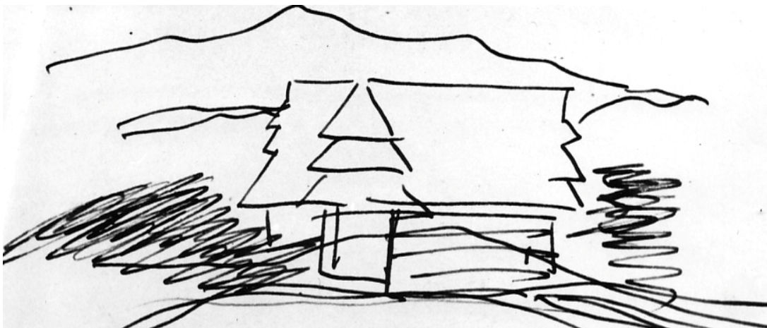
Il.17. Tatry Polskie. Analiza kształtowania się dachu szałas pasterskiego wg. profesora Andrzeja Skoczka. Źródło: A. Skoczek, O niektórych parametrach architektonicznych kształtowania dachów wiszących w środowisku Podhala , maszynopis niepublikowany, Kraków 1961
