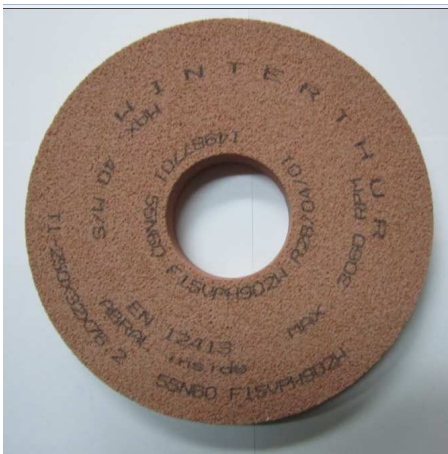
Rys. 3. Ściernica z nanokryształowego korundu spiekane go 93N f-my Rappold
