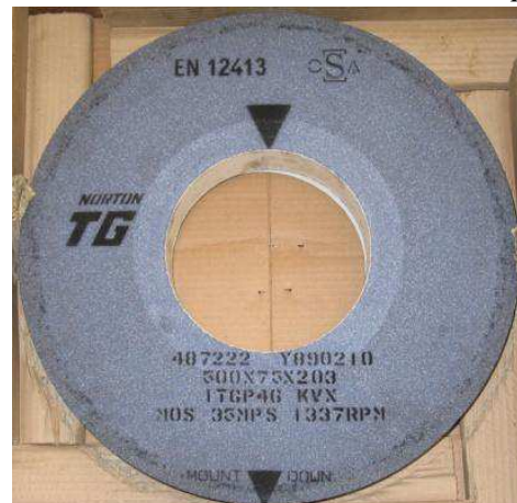
Rys. 4. Ściernica z mieszane go ścierniwa typu TGP (TG + CrA + 99A) f-my Saint Gobain Abrasives
