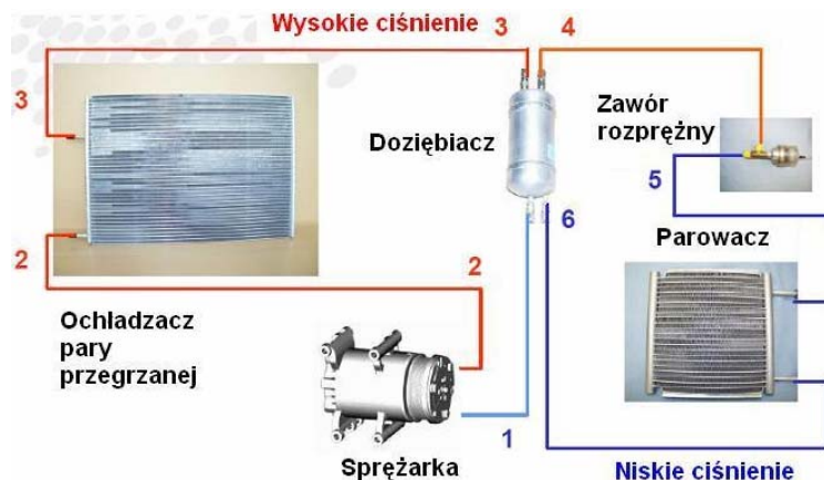
Ryc. 5. Schemat ideowy instalacji ziębniczej z CO 2 [4] (liczby dotyczą parametrów obiegu na ryc. 7)
